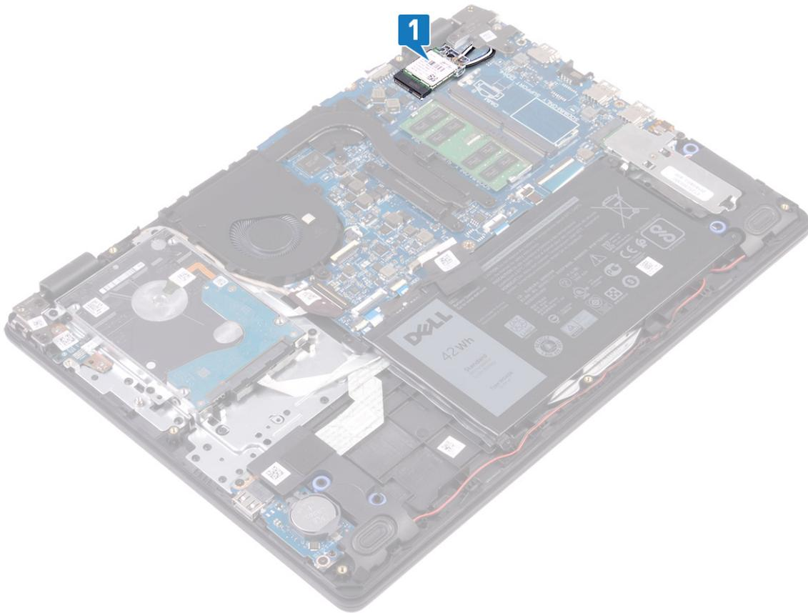
2. Retire o parafuso (M2x3) que fixa o suporte da placa sem fios à placa de sistema.
