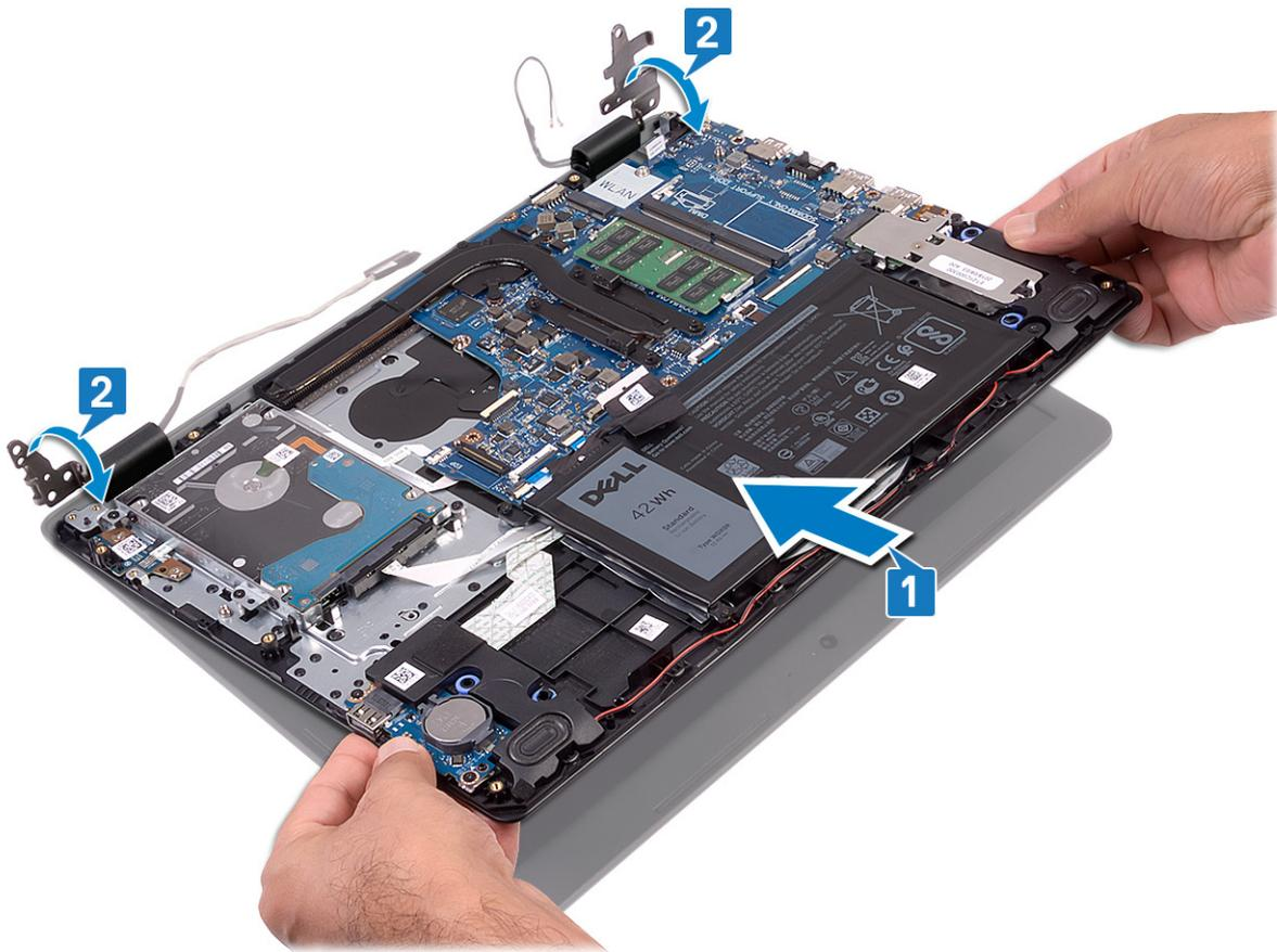
3. Volte a colocar os quatro parafusos (M2.5x4) que fixam as dobradiças do ecrã à placa de sistema e placa de E/S.
