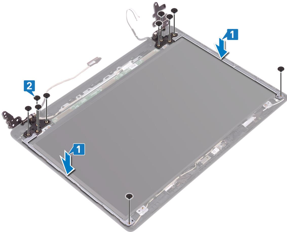
3. Encaminhe o cabo do ecrã e o cabo da antena através das dobradiças do ecrã.
