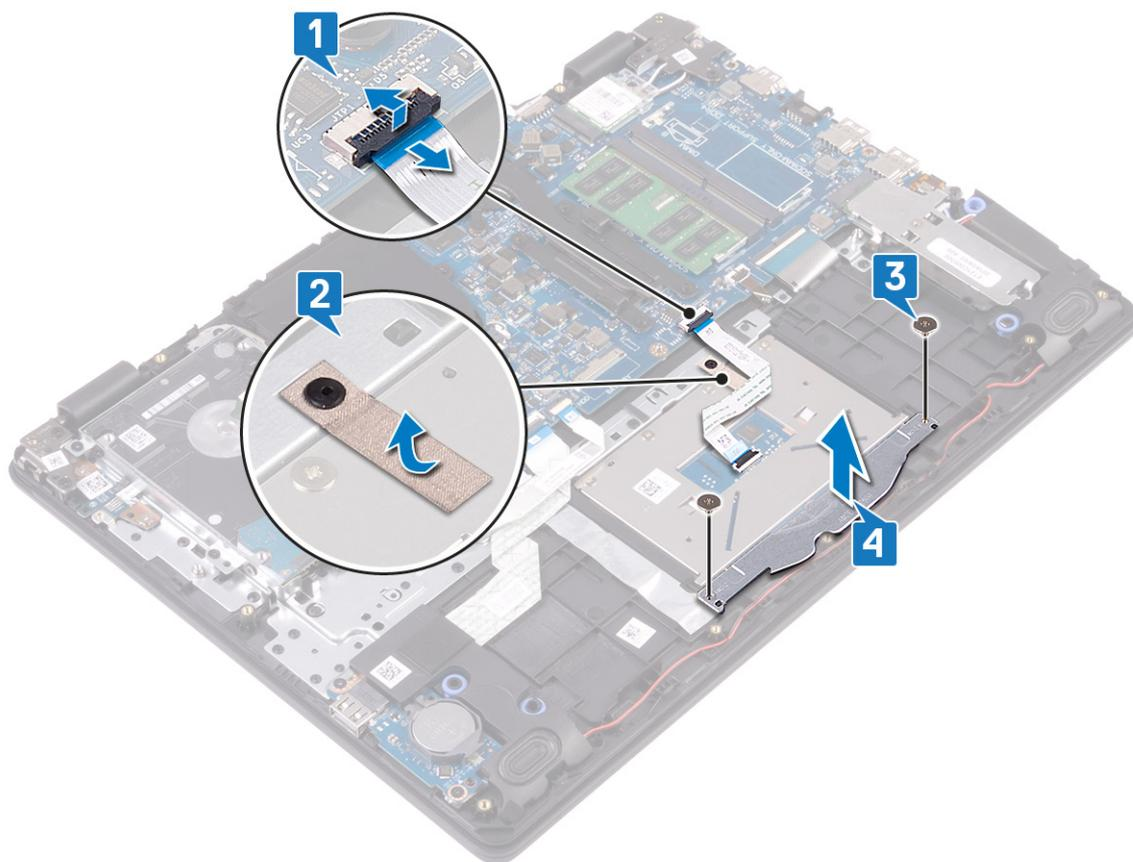
5. Retire os quatro parafusos (M2x2) que fixam a mesa sensível ao toque ao conjunto do teclado e apoio para as mãos.
