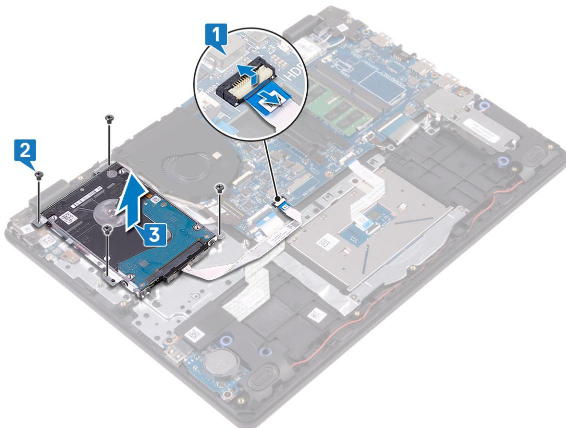
4. Desligue o elemento de interposição do conjunto da unidade de disco rígido.
