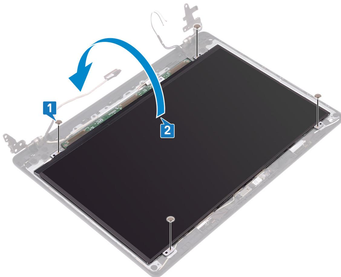
3. Retire a fita que fixa o cabo do ecrã à parte posterior do painel do ecrã.
