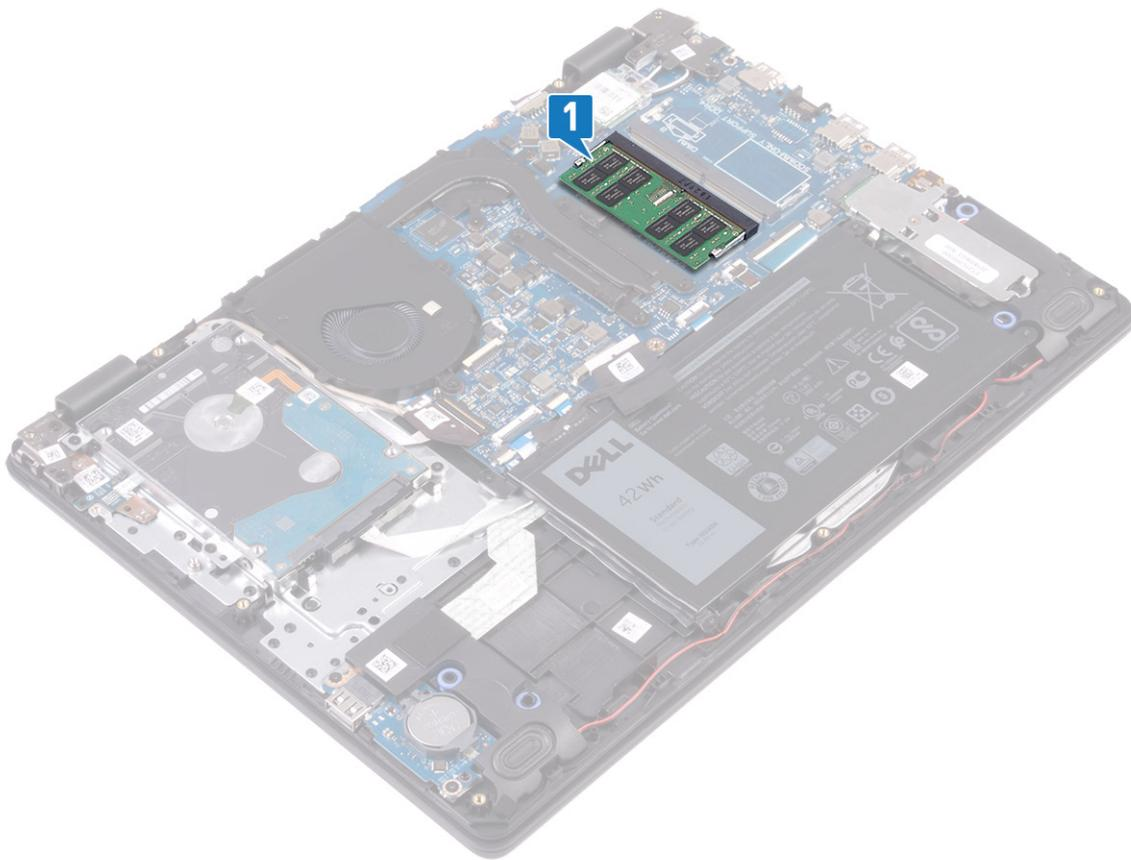
2. Utilize as pontas dos dedos para abrir cuidadosamente os grampos de fixação em cada uma das extremidades do encaixe do módulo de memória até que ele fique visível.
